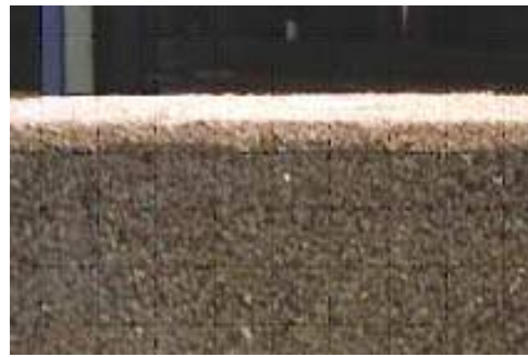
圖 7-22 透水性樹脂混合粒料之構造
