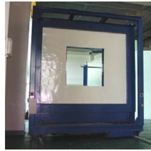
(b) 窗戶隔音測試設施
