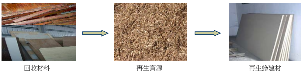
圖 6-2 木質材料回收製造再生綠建材流程
