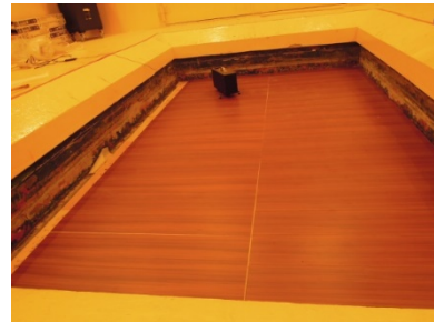
(b) 輕量衝擊源樓板衝擊音測試
