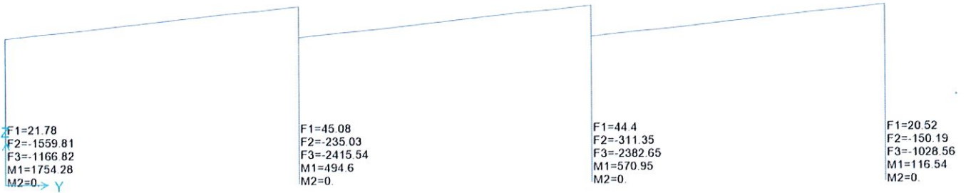
風載重柱底反力(風向 0°, 內風壓為負)
